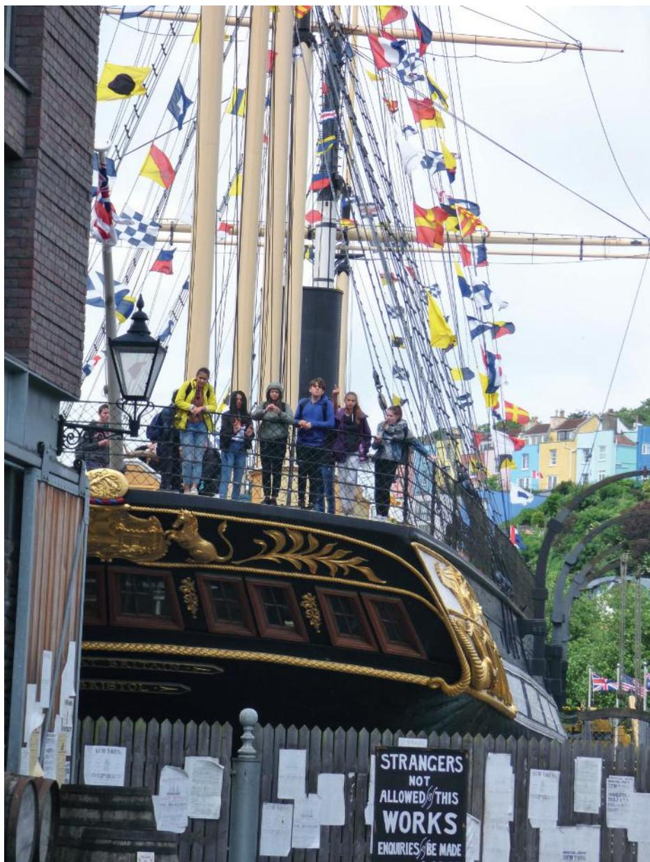
Le navire n'est pas construit avec du bois comme la plupart des autres bateaux de cette époque. La coque est constituée de fer. Il a une propulsion à hélice alors que généralement les bateaux étaient équipés de roues à aubes.
